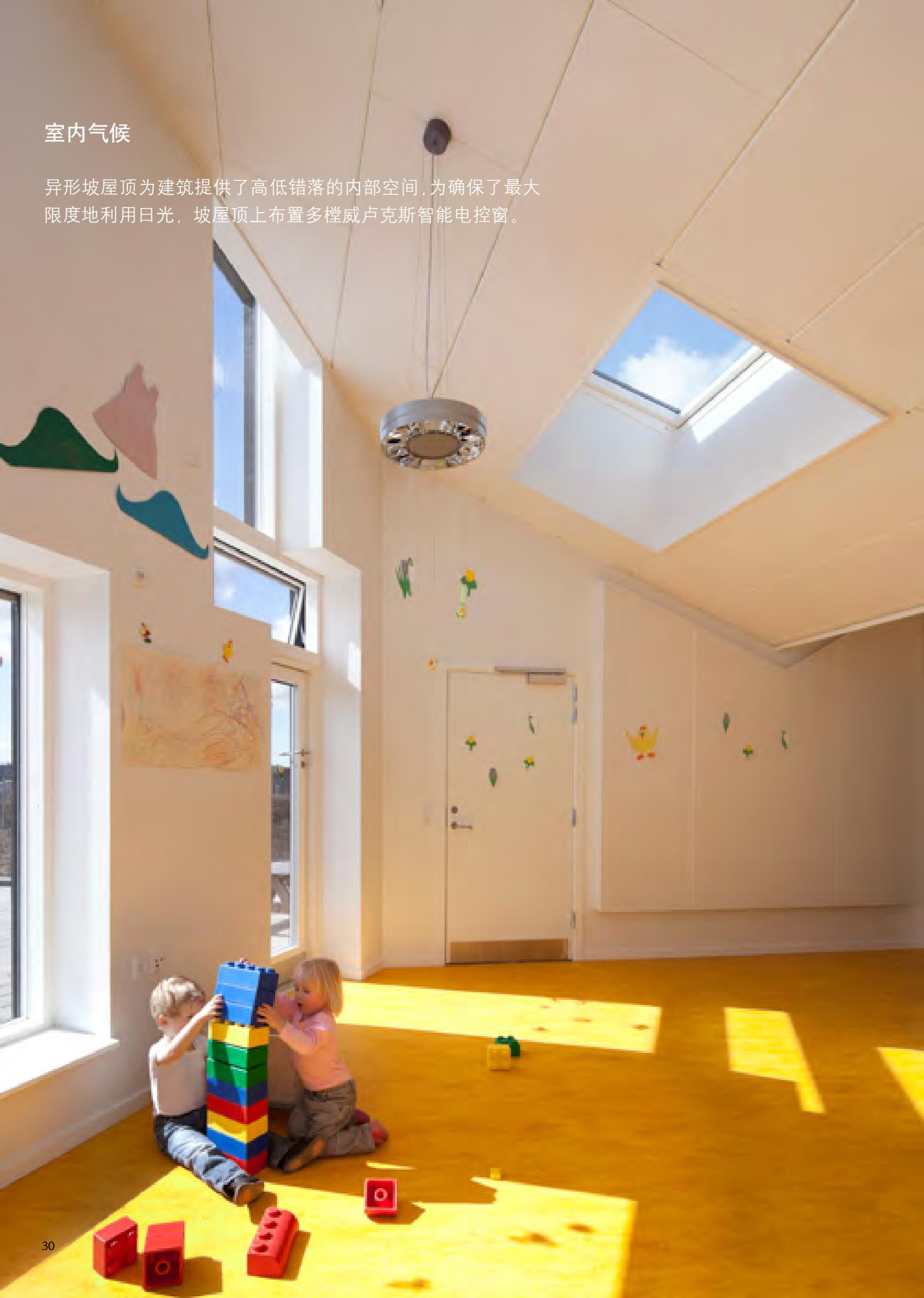
智能电控窗具有自动开关及定时开启等功能，可以保证房内空气流通良好。室内安装了多种检测探头，威卢克斯智能控制系统会根据室内温度自动打开窗户及换气设备，以循环室内新鲜空气。
