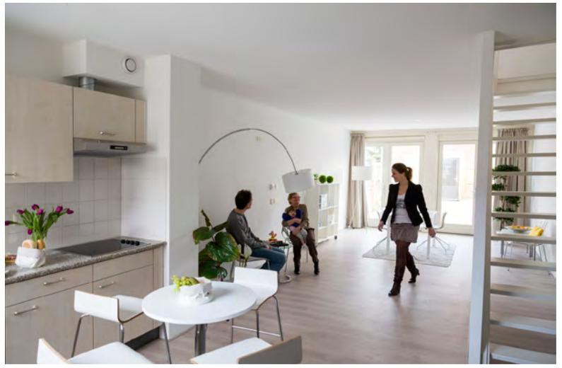
一楼和阁楼的通透性会影响房屋的自然通风效果。顶楼新开的几扇屋顶天窗在楼梯井边起到了烟囱的作用，使一二层的废气向上流通，最后从顶楼排到户外。这种设计还保障房屋在夏季的通风。冬季，配置 CO<sub>2</sub> 传感器的机械通风系统保障温暖空气流通，舒适而健康。
