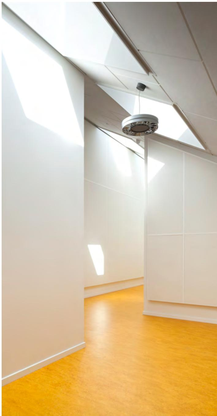
当阳光过于强烈时，室外遮阳帘会自动放下以遮挡过强的光线。日光通过东南及西南面的立窗以及顶部天窗照射进室内，使这所“太阳堡”获得的光照，比现行的建筑规范所要求的光照量高出3.5倍。
